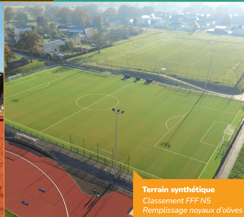
Terrain d'honneur et terrain synthétique : 4 mats d'éclairage LED (1500w par projecteur) avec gradation d'intensité lumineuse et programmation
